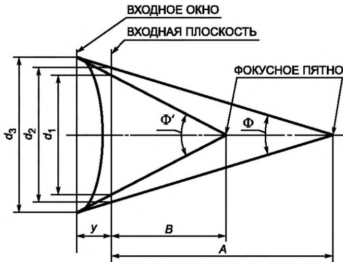
$d_1$  — РАЗМЕР РАБОЧЕГО ВХОДНОГО ПОЛЯ, соответствующий углу  $\Phi'/2$  (т. е. РИВ =  $B$ ),  $d_2$  — РАЗМЕР РАБОЧЕГО ВХОДНОГО ПОЛЯ, соответствующий углу  $\Phi/2$  (т. е. РИВ =  $A$ ), см;  $d_1$  — НОМИНАЛЬНЫЙ РАЗМЕР ВХОДНОГО ПОЛЯ УРИ ВО ВХОДНОМ ОКНЕ, см
