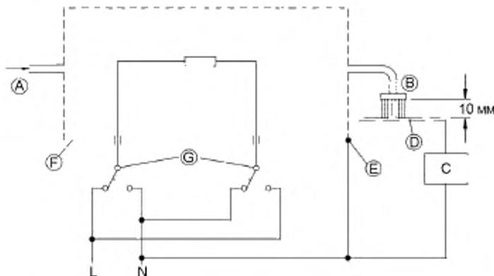
А — входная трубка; В — распылительная головка; С — цепь по МЭК 60990 (рисунок 4); Д — металлическая сетка; Е — зажим заземления; F — корпус водонагревателя; G — переключатель; L — фаза; N — нейтраль
