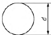
Рисунок 2 – Вид сверху тактильной точки с указанием диаметра
