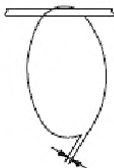
Рисунок 4 — Бунт со спиральностью, измеряемой под прямым углом к плоскости витка (метод А)
