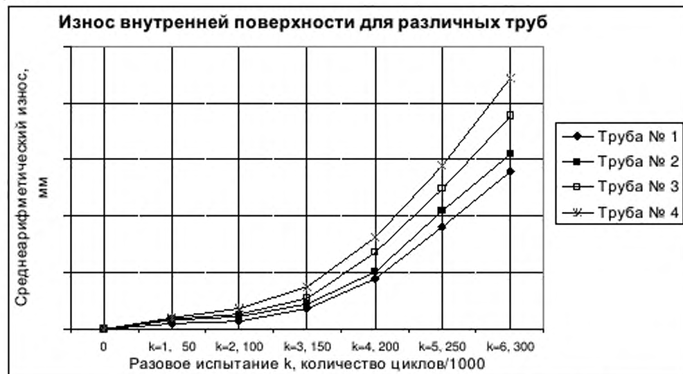
Рисунок 4 – Зависимость износа от количества испытательных циклов
