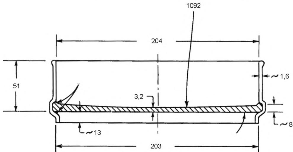
Причение — Все размеры указаны в мм; размер «1092» соответствует радиусу кривизны; для изготовления днища поддона можно использовать любой из перечисленных сплавов:
