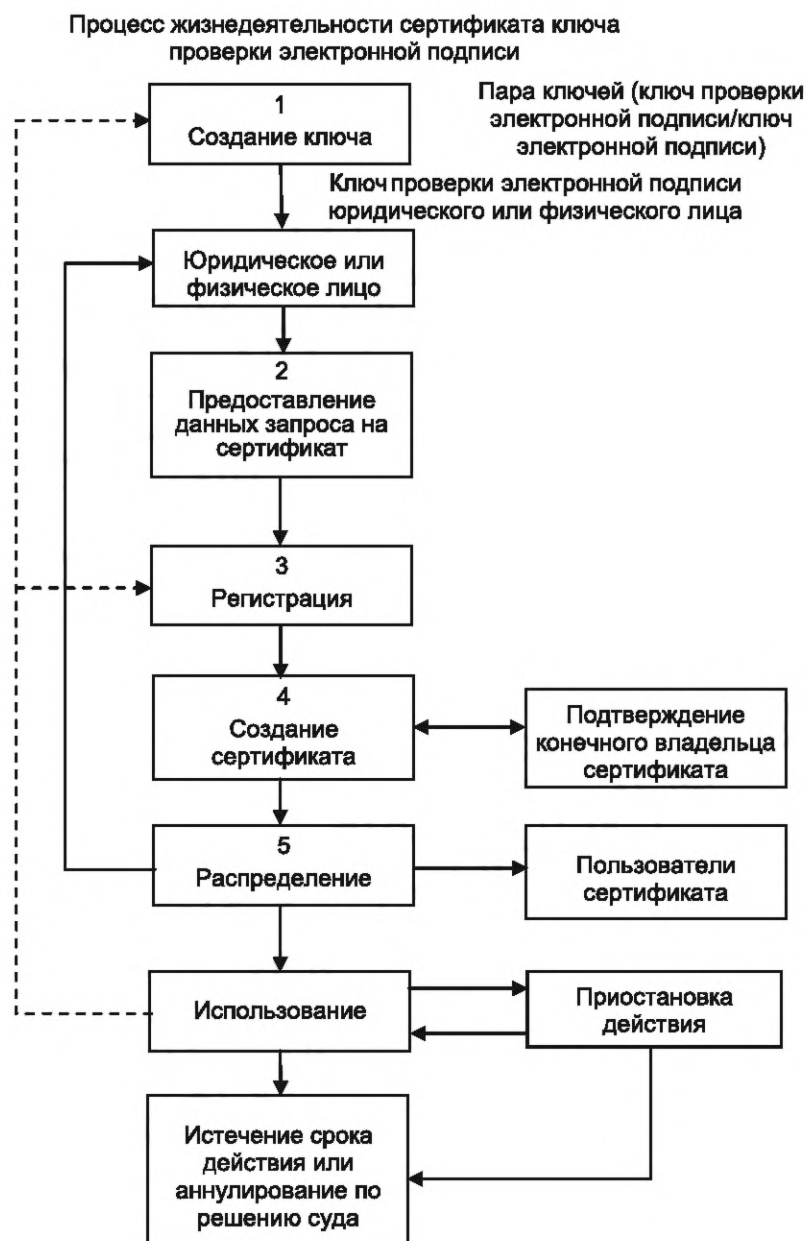
Рисунок 1 — Типовой процесс управления инфраструктурой открытых ключей
