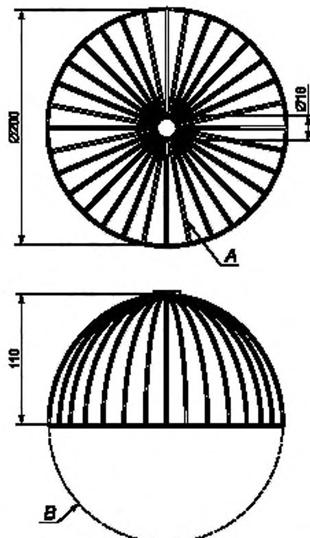
*A* — каркас, состоящий из 32 равномерно расположенных проволок диаметром  $(1,5 \pm 0,5)$  мм;
