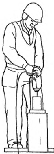
Рисунок 18 — Рабочая поза оператора при испытаниях отбойных, обрубных и клепальных молотков
