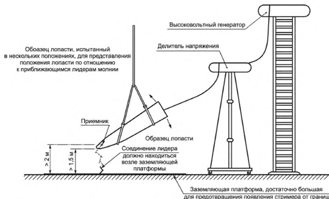
Рисунок D.1 — Схема установки А для испытаний на приложение начального лидера (образец необходимо испытать в нескольких положениях, отображая различные направления приближающегося лидера)
