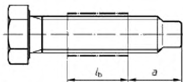
Рисунок 2 — Покрытия со специальной длиной и положением
