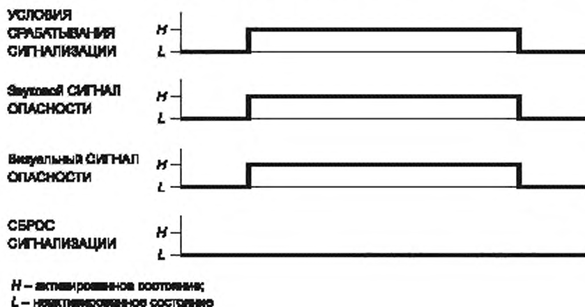
Рисунок ВВ.101 — СИГНАЛЫ ОПАСНОСТИ С АВТОМАТИЧЕСКИМ ОТКЛЮЧЕНИЕМ без СБРОСА СИГНАЛИЗАЦИИ
