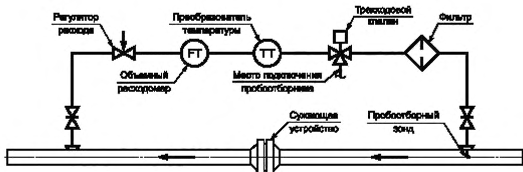
Рисунок 6 — Схема отбора проб с помощью сужающего устройства
