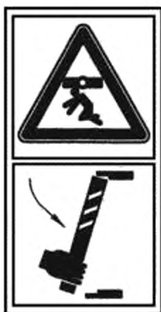
D.4 – Применяй механические опоры при техническом обслуживании и ремонте
