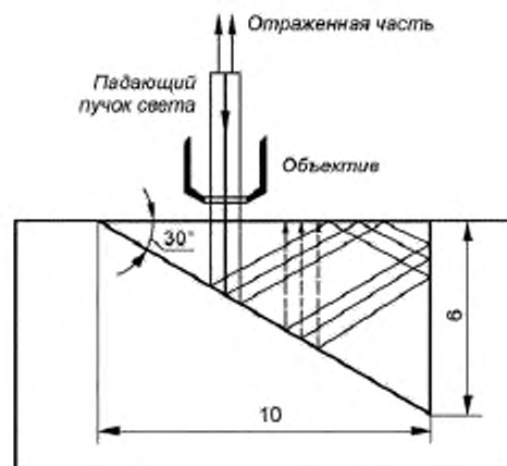
Рисунок 1 — Ход луча в клинообразном эталоне, вставленном в черную смолу, при фотометрических измерениях показателя отражения
