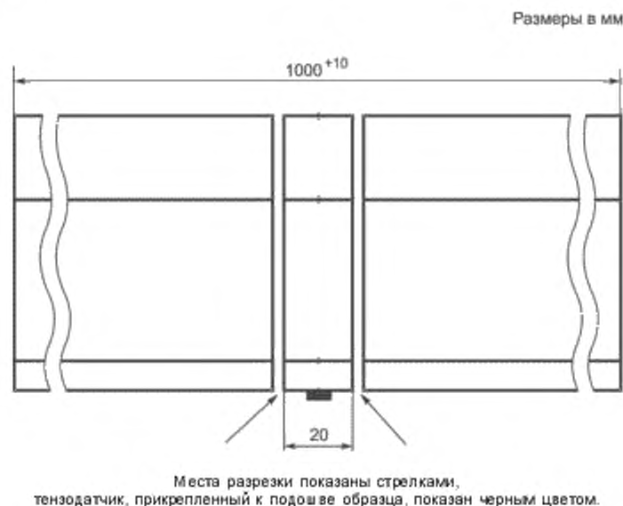
Рисунок 14 — Схема разрезки образца при определении остаточных напряжений в подошве рельса
