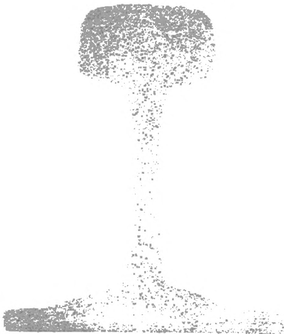
Рисунок И.1 — Макроструктура без ликвации (серый отпечаток)
