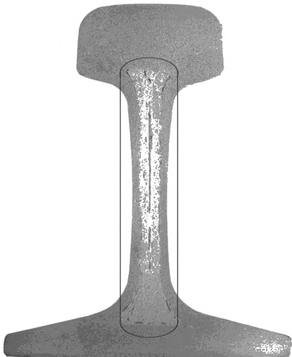
Рисунок И.8 — Несимметрично расположенные относительно вертикальной оси зоны повышенной и пониженной травимости при длине такой зоны более 15 мм (глубокое травление)
