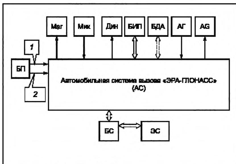
Mag — магнитола ATC; Mik — микрофон; Din — динамик; БИП — блок интерфейса пользователя; БДА — блок датчика аварии; АГ — антenna ГЛОНАСС; AG — антenna GSM/UMTS; БП — блок питания (12/24 В); БС — блок сопряжения; ЭС — эмулятор системы «ЭРА-ГЛОНАСС», 1 — кабель питания; 2 — цепь зажигания
