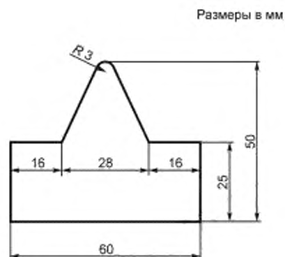
Рисунок 2 — Поперечный профиль и размеры бойка
