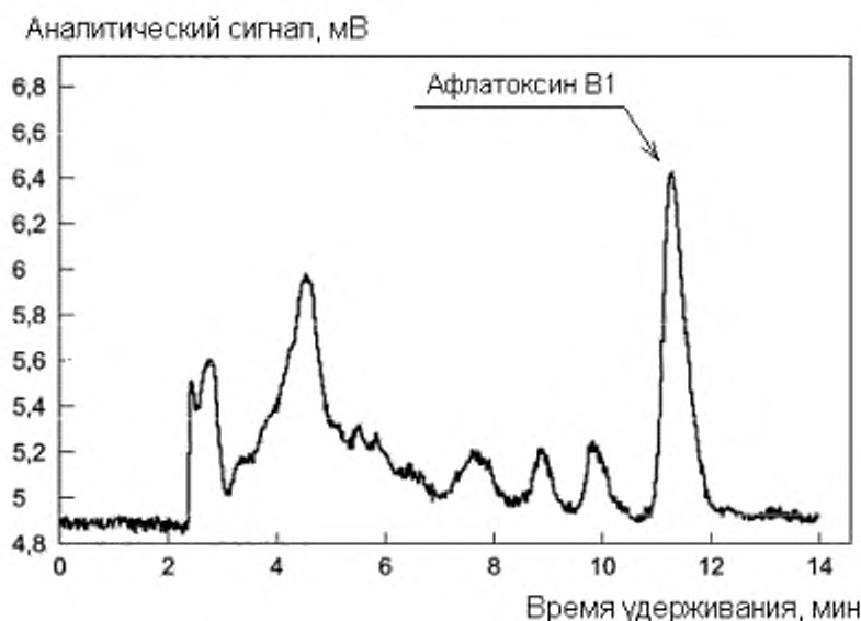
Рисунок А.1 – Пример типичной хроматограммы при определении афлатоксина В 1 в продукте для питания детей раннего возраста с применением очистки экстракта на иммуноаффинной колонке. Содержание афлатоксина В 1 – 0,1 мкг/кг
