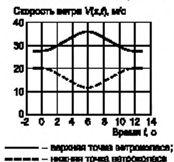
Рисунок 9 — Пример скорости ветра в верхней и нижней точках ветроколеса
