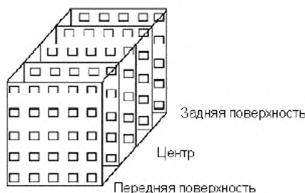
Рисунок 1 — Размещение дозиметров для картирования дозы в контейнере с продуктом в случае фотонного облучения.
