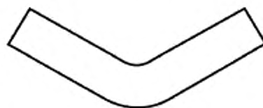
Рисунок Б.7 — Пластичный сдвиг
