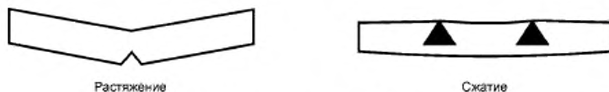
Рисунок Б.6 — Типы разрушения без сдвигов
