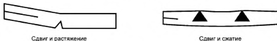
Рисунок Б.5 — Смешанные типы разрушения
