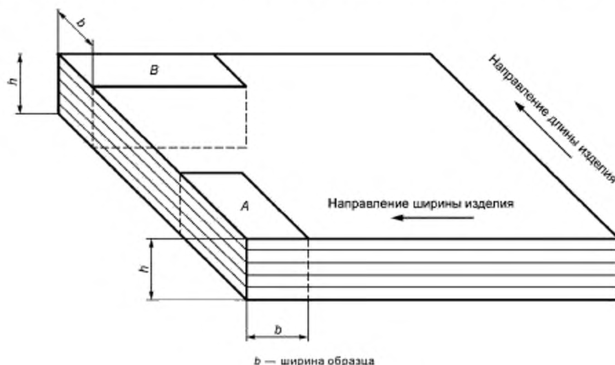
Рисунок Б.3 — Расположение образцов
