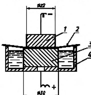
Электролитическая ячейка (см. чертеж) состоит из двух медных электродов с плоскими параллельными друг другу поверхностями. К электродам прикладывается постоянное напряжение в 1,2 В.
