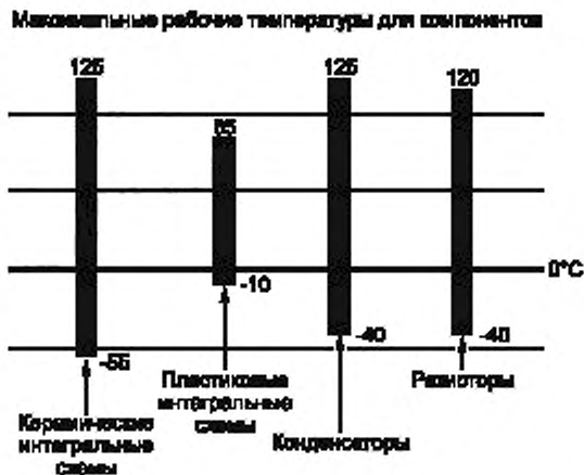
Рисунок 24 — Температурные пределы компонентов
