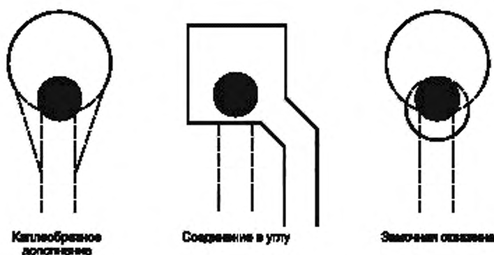
Рисунок 17 — Примеры измененных соединений проводника и контактной площадки
