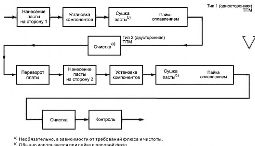
Рисунок 29 — Типовой процесс оплавления для поверхностного монтажа типов 1b и 2b технологии поверхностного монтажа
