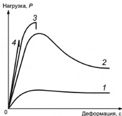
Рисунок Б.1 — Диаграммы «нагрузка — деформация» для льда, испытываемого при различных постоянных скоростях деформации: \dot{\varepsilon}_1 < \dot{\varepsilon}_2 < \dot{\varepsilon}_3 < \dot{\varepsilon}_4
