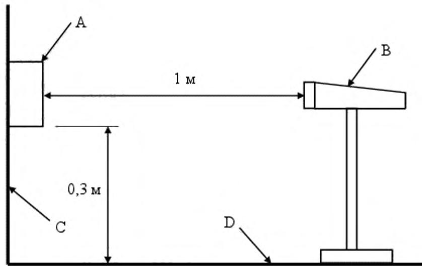
А — сигнализатор; В — микрофон; С — стена (вертикальная поверхность); D — пол или потолок (горизонтальная поверхность)
