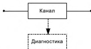
Рисунок В.4 – Структурная схема архитектуры 1001
