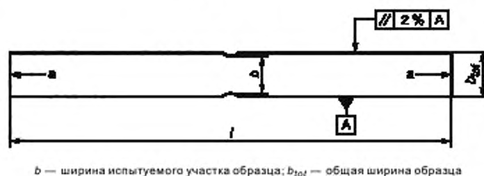
Рисунок 7 — Образец для испытания на разрыв фрагмента стенки трубы (угол намотки слоев более 70^\circ )
