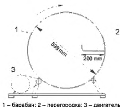
Рисунок 1 – Структура барабана для определения прочности
