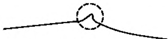
Рисунок 25 — Кривая с малым радиусом кривизны
