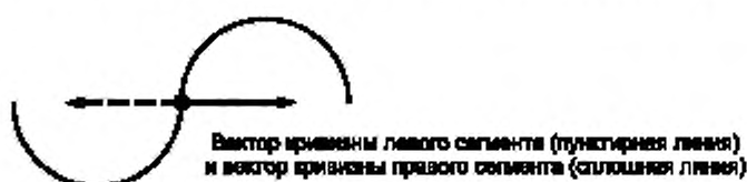
Рисунок 21 — Разрыв G2 вследствие разных направлений радиусов кривизны
