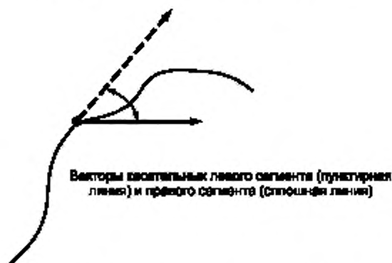
Рисунок 19 — Кривая, имеющая разрыв G1
