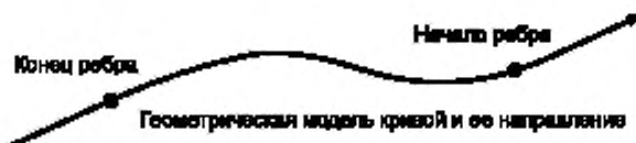
Рисунок 6 — Несогласованные направления ребра и кривой
