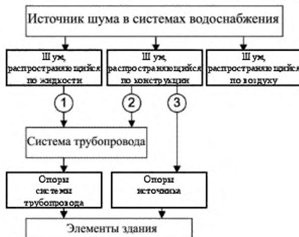
Рисунок 4 – Пути звукопередачи от источников шума в системах водоснабжения
