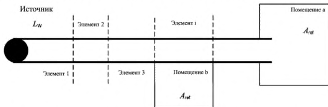
Рисунок 1 – Звукопередача от источника воздушного шума по зданию через систему воздуховодов в приемные помещения (а и б)
