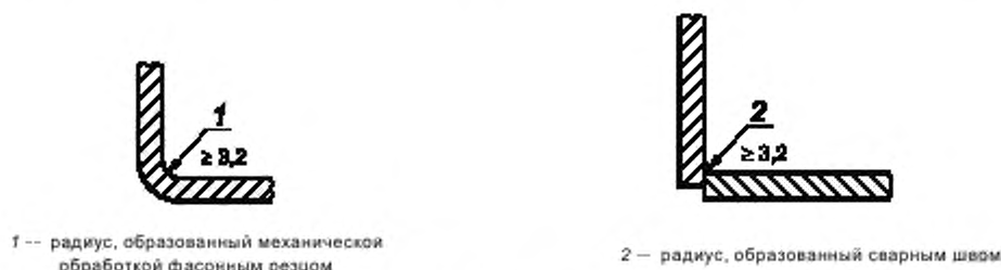
Рисунок А.2 — Углы и радиусы в пищевой зоне
