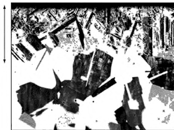
Рисунок 10 — Пример образования эpsilon-мартенсита в обезуглероженной поверхностной зоне закаленной аустенитной марганцовистой стали, содержащей менее 0,5\% углерода (100 \times , травление 2 %-ным спиртовым раствором азотной кислоты в течение 5 с, а затем 20 %-ным водным раствором пиросульфата натрия в течение 20 с)
