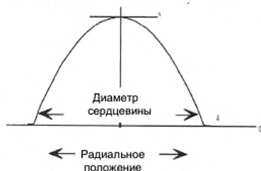
Рисунок С.1 – Диаметр поперечного сечения сердцевины. Сканирование интенсивности ближнего поля, способ 1
