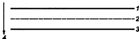
1 — предварительный фильтр; 2 — уплотнительное кольцо; 3 — фильтр для отбора проб, 4 — направление потока воздуха через пробоотборник
