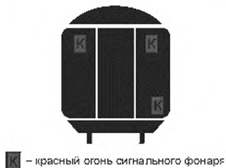
Рисунок 1 — Размещение сигнальных фонарей на торцевых стенах вагона
