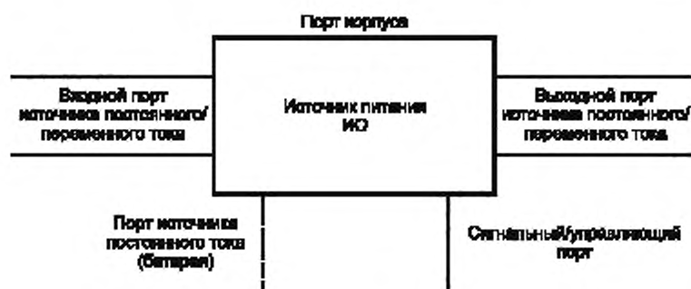
Рисунок 5 — Обозначение портов испытываемого оборудования
