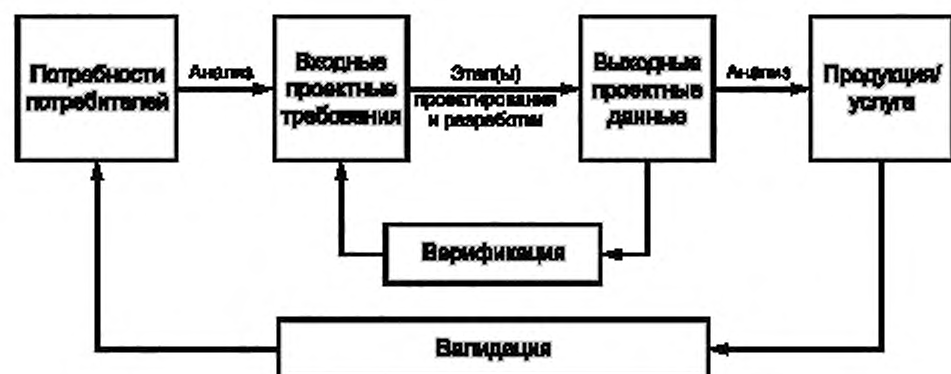
Рисунок 3 — Упрощенная схема взаимосвязи между верификацией и валидацией в процессе проектирования и разработки
