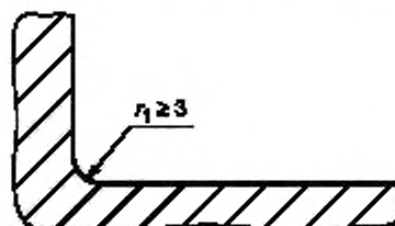
Рисунок А.1 — Пищевая зона. Закругленная кромка с радиусом большим, чем кривая с минимальным радиусом r_1 = 3 мм
