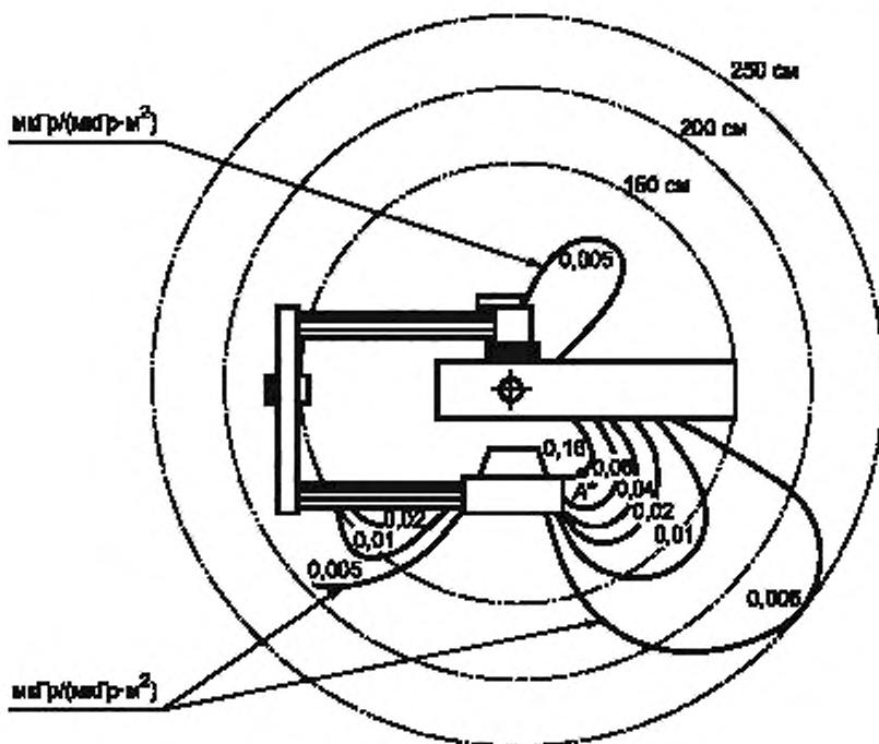
\* Пример определения дозы неиспользуемого излучения в месте расположения персонала (точка А): за время проведения исследований встроенный в аппарат измеритель ПРОИЗВЕДЕНИЯ ДОЗА  $\times$  ПЛОЩАДЬ показал суммарное значение, например 100  $\mu\text{Гр} \cdot \text{м}^2$ . Тогда значение суммарной дозы неиспользуемого излучения в точке А составит 16  $\mu\text{Гр}$ .
