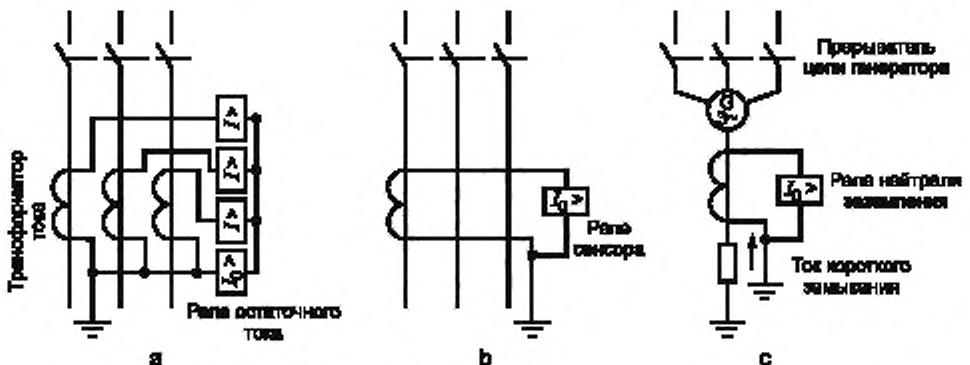
а — остаточная схема релейной защиты (не применяется для низковольтных четырехпроводных систем);
