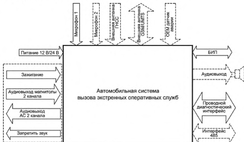
Рисунок Г.1 — Пример подключения АС к аудиосистеме транспортного средства
