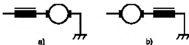
Рисунки 2а) и 2б) — Соединение обмотки возбуждения/якоря электродвигателя с последовательным возбуждением
