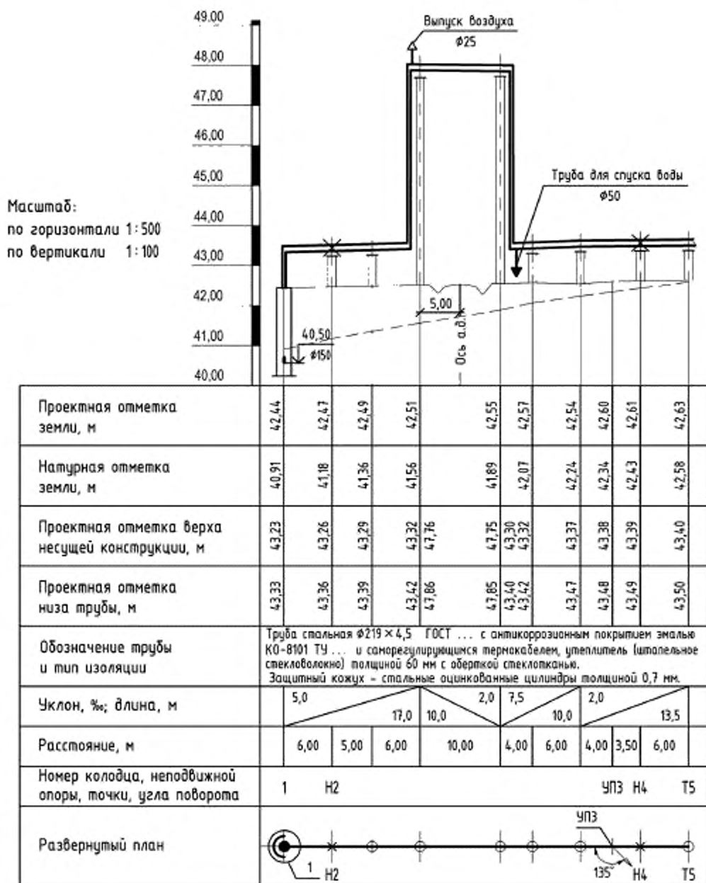
Рисунок В.3 — Пример выполнения профиля напорной сети при подземной прокладке
