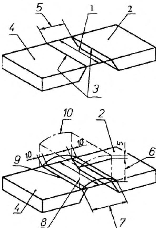
1 — ширина строгания; 2 — входной стол; 3 — края; 4 — выходной стол; 5 — ширина щели; 6 — высота деревянного изделия для максимально отрегулированного мостика; 7 — ширина мостика; 8 — длина мостика, предназначенная для закрывания ножей; 9 — мостик плоско прилегает к столу; 10 — мостик отрегулирован на максимальную высоту
