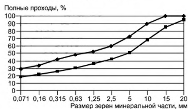
Рисунок В.1 — Зерновой состав смеси типа I (круглые сита)
