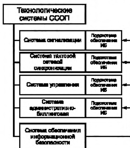
Рисунок 4 — Взаимосвязь СОИБ с технологическими системами ССОП
