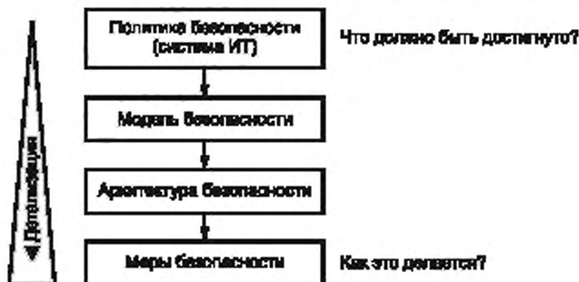
Рисунок Д.1 — Модель безопасности
