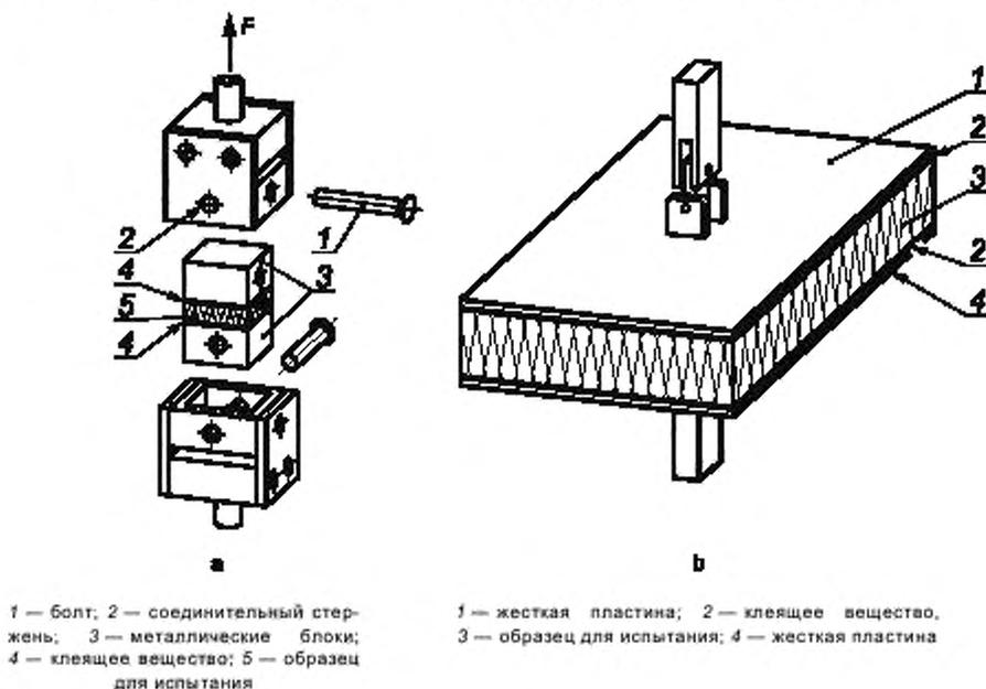
Рисунок 1 — Примеры приспособлений для крепления образца
