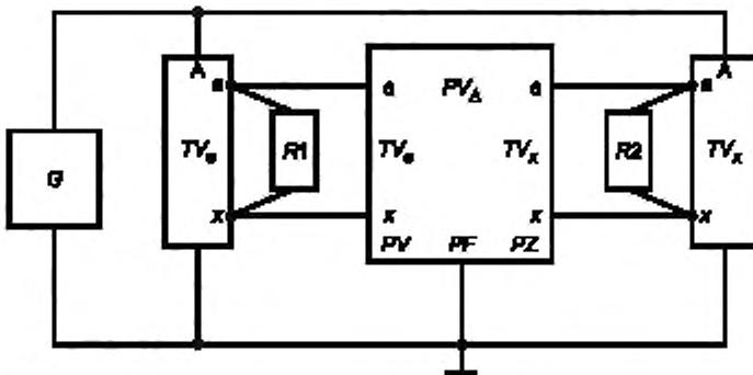
$G$  — источник высокого напряжения;  $TV_s$  — эталонный трансформатор;  $R1$  — нагрузочное устройство эталонного трансформатора,  $TV_x$  — поверяемый трансформатор;  $R2$  — нагрузочное устройство поверяемого трансформатора;  $PV_A$  — прибор сравнения,  $PV$  — функция измерения входного напряжения;  $PF$  — функция измерения частоты входного напряжения,  $PZ$  — функция измерения нелинейных искажений
