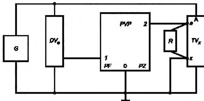
$G$  — источник высокого напряжения;  $DV_s$  — эталонный делитель,  $R$  — нагрузочное устройство поверяемого трансформатора;  $TV_x$  — поверяемый трансформатор.  $PVP$  — вольтфазометр;  $PF$  — функция измерения частоты входного напряжения;  $PZ$  — функция измерения нелинейных искажений
