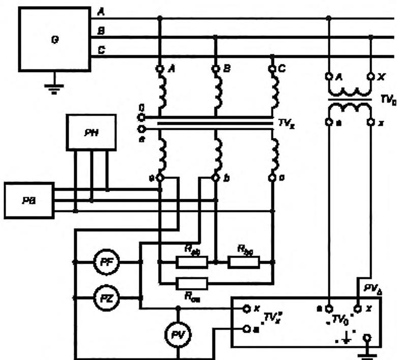
$G$  — источник трехфазной системы напряжений;  $TV_x$  — поверяемый трансформатор,  $TV_0$  — эталонный трансформатор;  $RH$  — фазоуказатель;  $PB$  — измеритель несимметрии;  $PZ$  — измеритель нелинейных искажений;  $PF$  — частотомер,  $PV$  — вольтметр с пределом измерения 150 В (подключается в случае отсутствия встроенного вольтметра в приборе сравнения);  $R_{ab}$ ,  $R_{bc}$ ,  $R_{ca}$  — нагрузочные устройства поверяемого трансформатора;  $PV_\Delta$  — прибор сравнения
